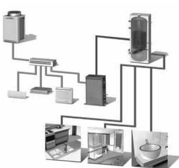
Il sistema consente di produrre acqua calda sanitaria, applicando un modulo idronico agli impianti ad espansione diretta .
