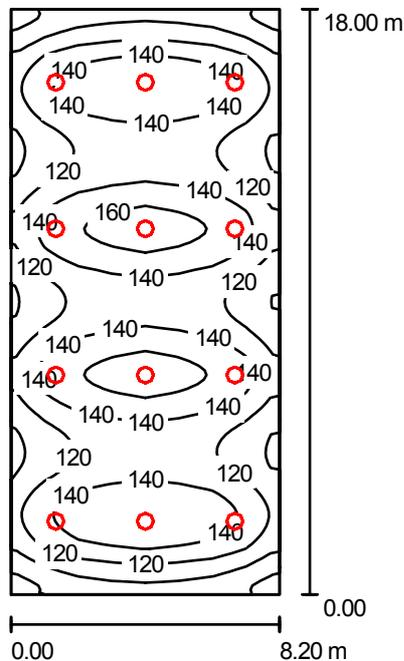
Altezza locale: 3.500 m, Altezza di montaggio: 3.500 m, Fattore di manutenzione: 0.80
