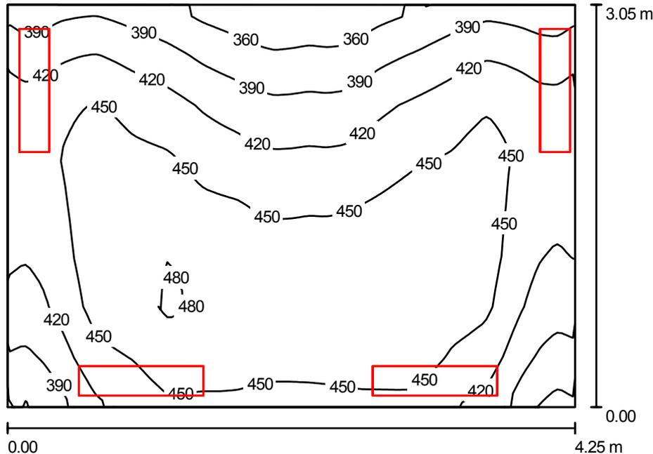
Altezza locale: 3.000 m, Altezza di montaggio: 3.000 m, Fattore di manutenzione: 0.80
