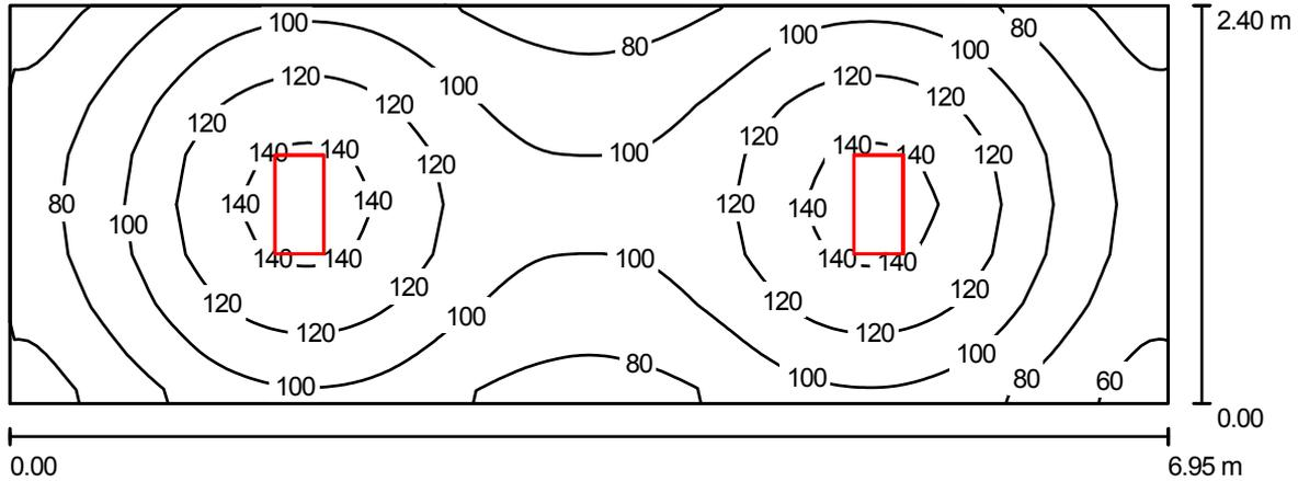
Altezza locale: 3.000 m, Altezza di montaggio: 3.000 m, Fattore di manutenzione: 0.80
