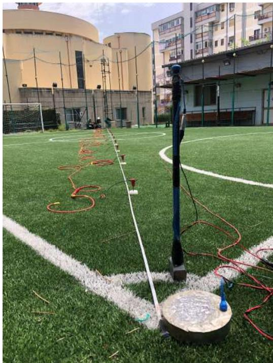
Foto 2 – Momenti di acquisizione sismica SS2
