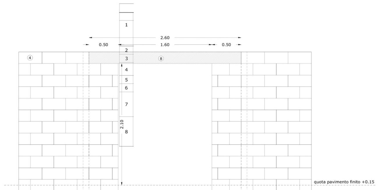
Prospetto architrave in corrispondenza delle aperture - scala 1:20
