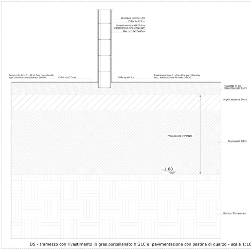
D5 - tramezzo con rivestimento in gres porcellanato h:210 e pavimentazione con pastina di quarzo - scala 1:10
