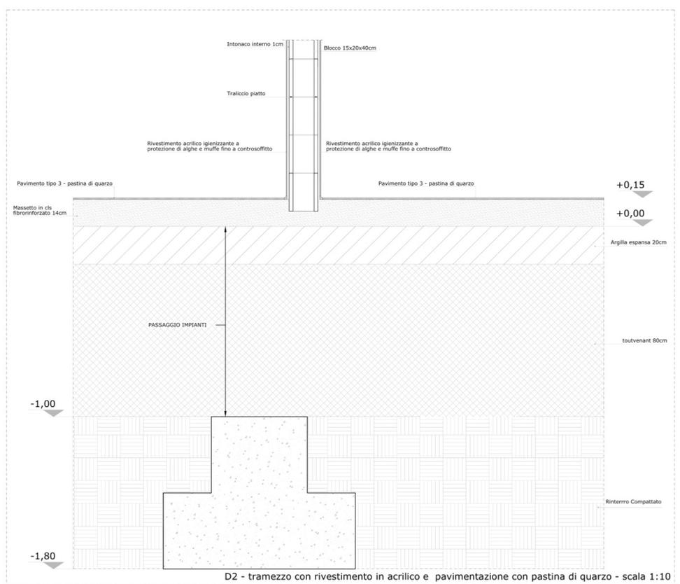
D2 - tramezzo con rivestimento in acrilico e pavimentazione con pastina di quarzo - scala 1:10
