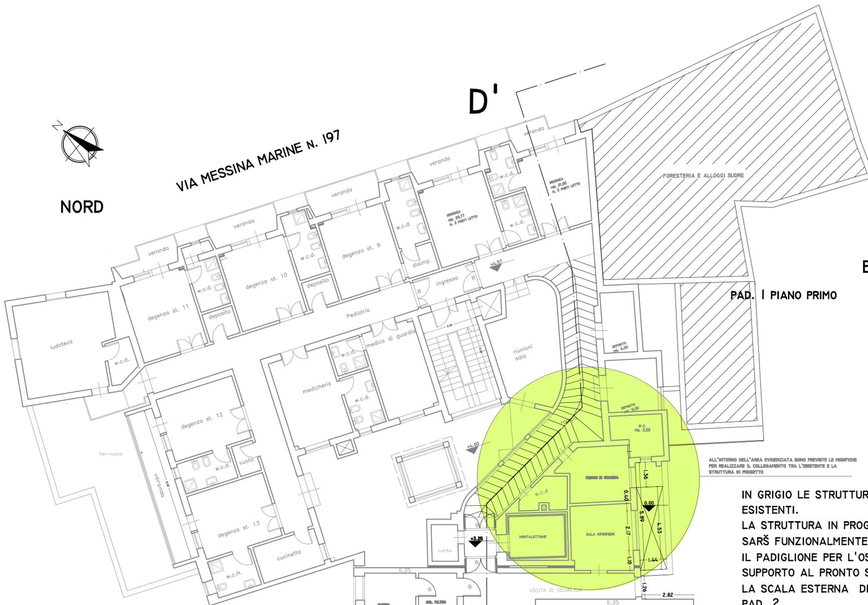
ALL'INTERNO DELL'AREA EVIDENZIATA SONO PREVISTE LE MODIFICHE PER REALIZZARE IL COLLEGAMENTO TRA L'ESISTENTE E LA STRUTTURA IN PROGETTO
