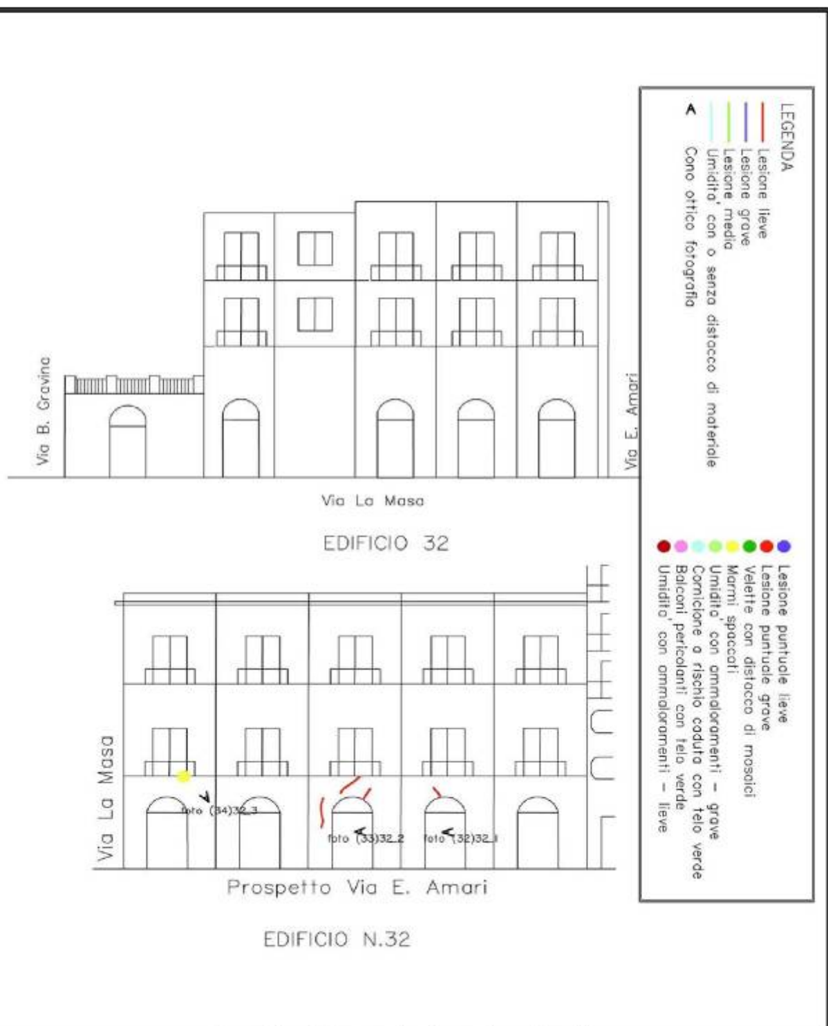
Prospetto edificio e quadro fessurativo evidenziato
