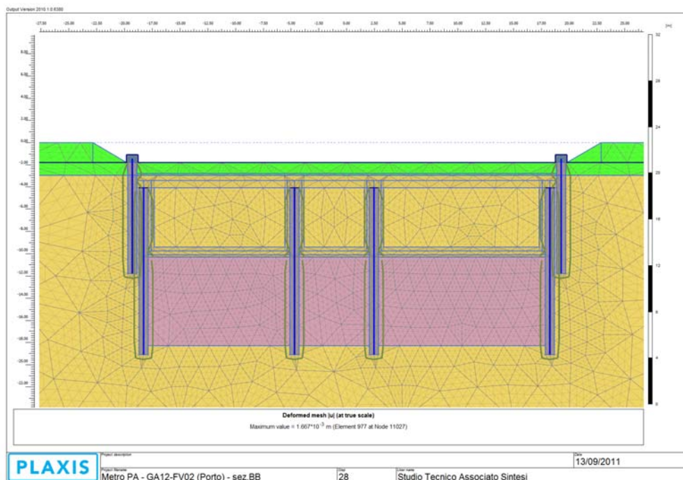
Figura 65 – Esecuzione delle paratie e del tampone di fondo in jet-grouting
