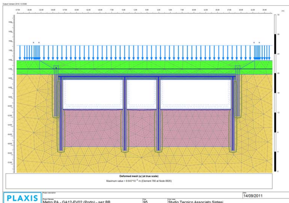
Figura 68 – Raggiungimento dello scavo massimo interno
