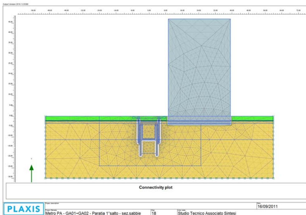
Figura 49 – Discretizzazione adottata nella analisi della sezione 41
