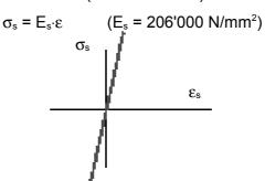
limite sforzo in compressione/trazione
