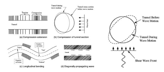
Valutazioni accurate dell'interazione sismica fra galleria e terreno possono essere condotte tramite l'impiego di modelli ad elementi finiti. Tuttavia con ragionevole approssimazione il calcolo delle sollecitazioni longitudinali e trasversali può essere condotto con formulazioni semplificate, che si basano su correlazioni cinematiche fra il moto delle onde sismiche e le deformazioni nella galleria.
