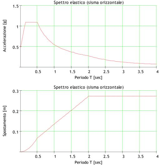
Spettro elastico di accelerazione e spostamento al sito di Palermo (suolo cat. B-C-E,  $\gamma_{imp}$ =1.4)
