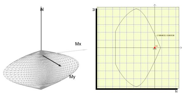
Si riportano di seguito i valori dei momenti resistenti in assenza di sollecitazione normale per  $R_{ck} = 15 \text{ N/mm}^2 \text{ e per } R_{ck} = 45 \text{ N/mm}^2$ :
