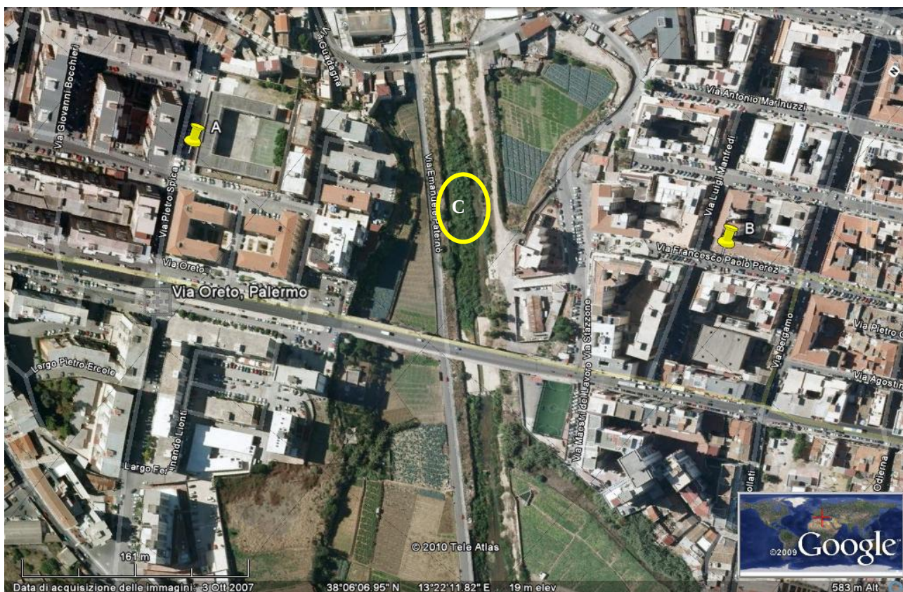
Fig. 6.- Immagine satellitare del decorso rettilineo del fiume Oreto a causa della cementificazione del suo alveo, nel tratto in cui la metropolitana lo sottopassa.
