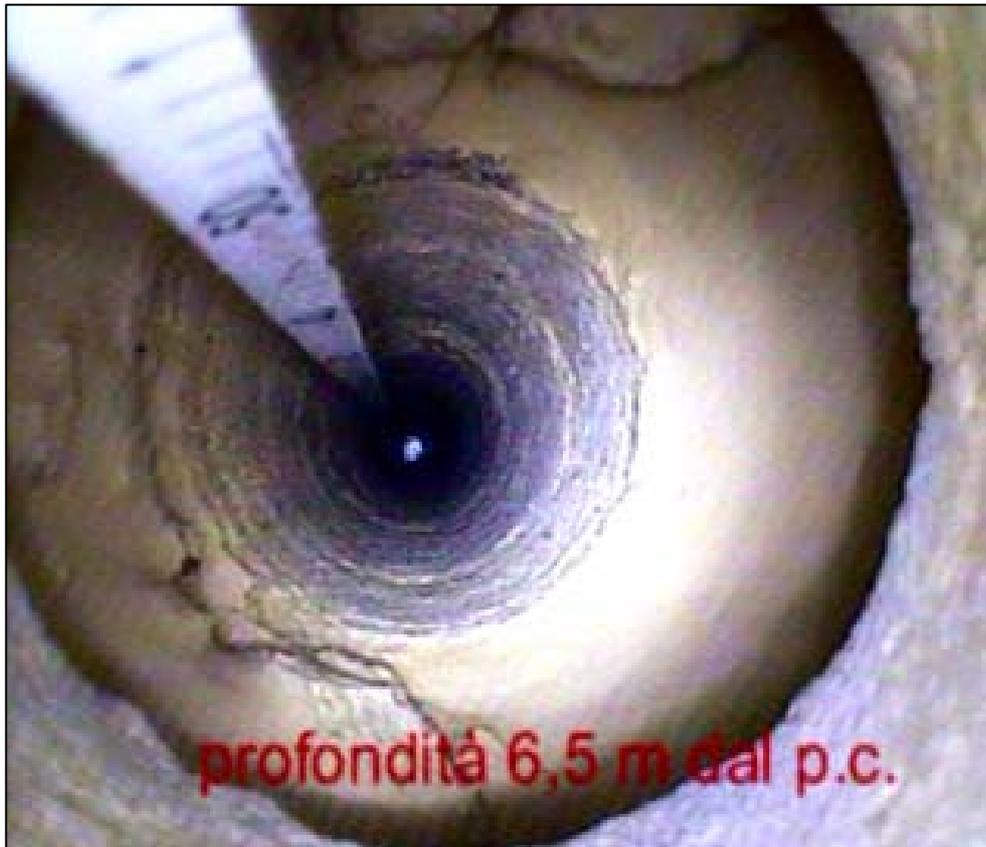
Foto 5 – Ripresa sondaggio S1-B41 a 6,5 m – Via Scarlatti
