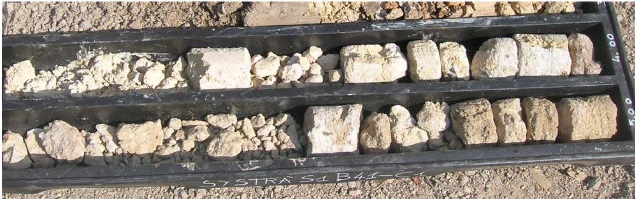
Foto 1 - Sondaggio S1B41 da 3 m a 5 m – Via Scarlatti – Calcarenite biancastra
