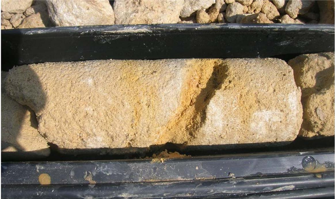
Foto 3 - Sondaggio S2-79 da 5 m a 10 m – Via Maqueda – Calcarenite giallastra
